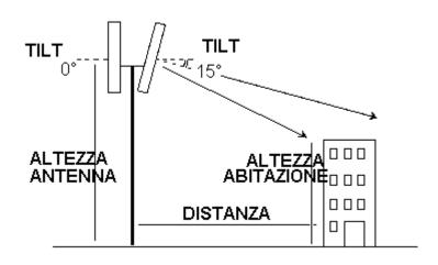
Il campo di un'antenna tipo si riduce a 0,5 volt/metro a circa 500 metri dall'antenna e allontanandosi si riduce molto lentamente. La distanza di 150 metri non è di per sé garanzia dell'ottenimento dei valori di campo elettromagnetico necessariamente più bassi di quelli che si hanno a distanze inferiori. Infatti l'andamento del campo elettromagnetico di un'antenna tipo con potenza in ingresso di 50 watt installata su un palo di altezza 30 metri con tilt di 2° è il seguente.
